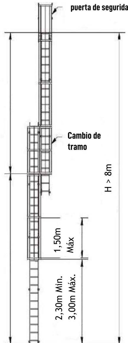
Las escaleras con protección dorsal de GM cumplen con las normas EN14122-4 y NF E 85-016. Estos equipos permiten garantizar la seguridad contra caídas en trabajos en altura.
