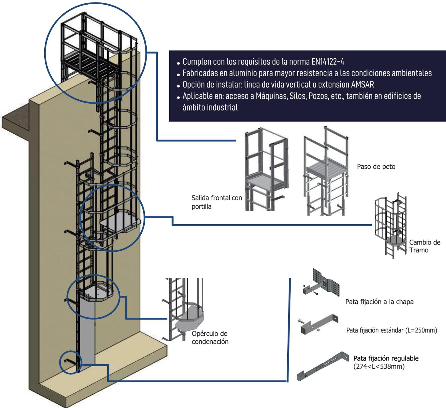
Las escaleras con protección dorsal de GM cumplen con las normas EN14122-4 y NF E 85-016. Estos equipos permiten garantizar la seguridad contra caídas en trabajos en altura.
